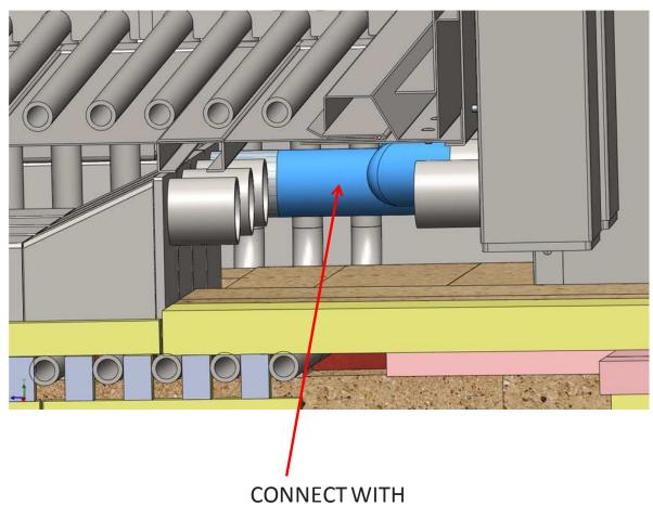
FLEX STAINLESS STELL TUBE Ø60, THE STEAMER WITH STEAMER DISCHARGE
