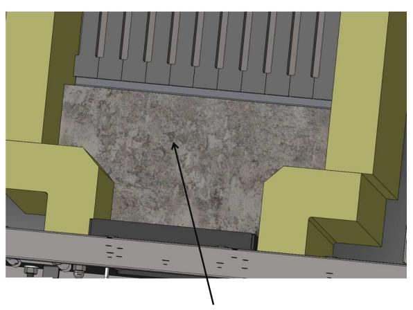
MAKE A LAYER OF NORMAL CONCRETE UNTIL THE HEIGHT OF THE GRIDS LESS 4 CM
