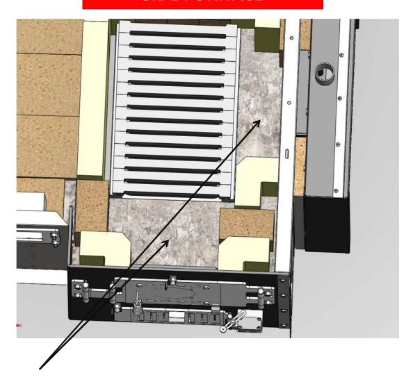
MAKE A LAYER OF NORMAL CONCRETE UNTIL THE HEIGHT OF THE GRIDS LESS 4 CM
